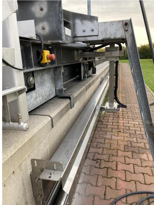
Abb. 5: Führung der IGUS Energiekette
